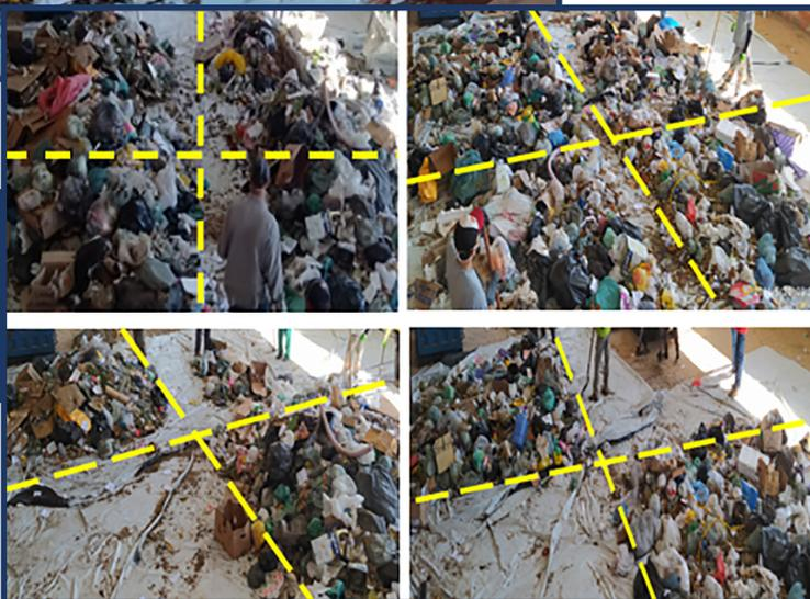
Figura 2 - Procedimento de quarteamento para amostragem
